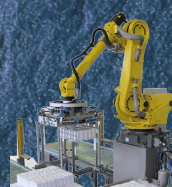
ΠΑΛΕΤΟΠΟΙΗΤΗΣ ΤΥΠΟΥ ROBOT ΓΙΑ ΤΗΝ ΑΥΤΟΜΑΤΗ ΠΑΛΕΤΟΠΟΙΗΣΗ ΧΑΡΤΟΚΙΒΩΤΙΩΝ-ΔΕΜΑΤΩΝ
