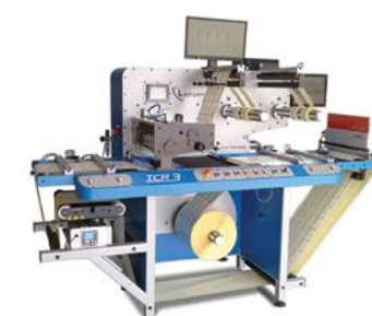
ICR3: Για έλεγχο εκτυπώσεων, slitting, rewinding
