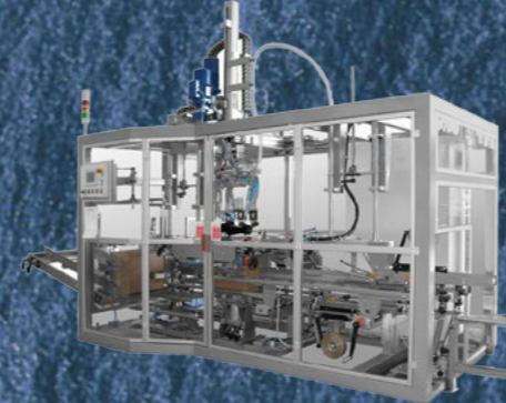
ΕΓΚΙΒΩΤΙΣΤΗΣ ΤΥΠΟΥ COMBI ΓΙΑ ΤΗΝ ΔΙΑΜΟΡΦΩΣΗ ΤΟΥ ΧΑΡΤΟΚΙΒΩΤΙΟΥ, ΤΟΝ ΕΓΚΙΒΩΤΙΣΜΟ, ΚΑΙ ΤΗΝ ΚΟΛΛΗΣΗ ΤΟΥ ΧΑΡΤΟΚΙΒΩΤΙΟΥ.
