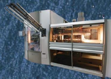
ΜΟΝΟΜΠΛΟΚ ΜΗΧΑΝΗΜΑ ΚΑΤΑΣΚΕΥΗΣ ΚΑΙ ΕΜΦΙΑΛΩΣΗΣ ΦΙΑΛΩΝ PET
