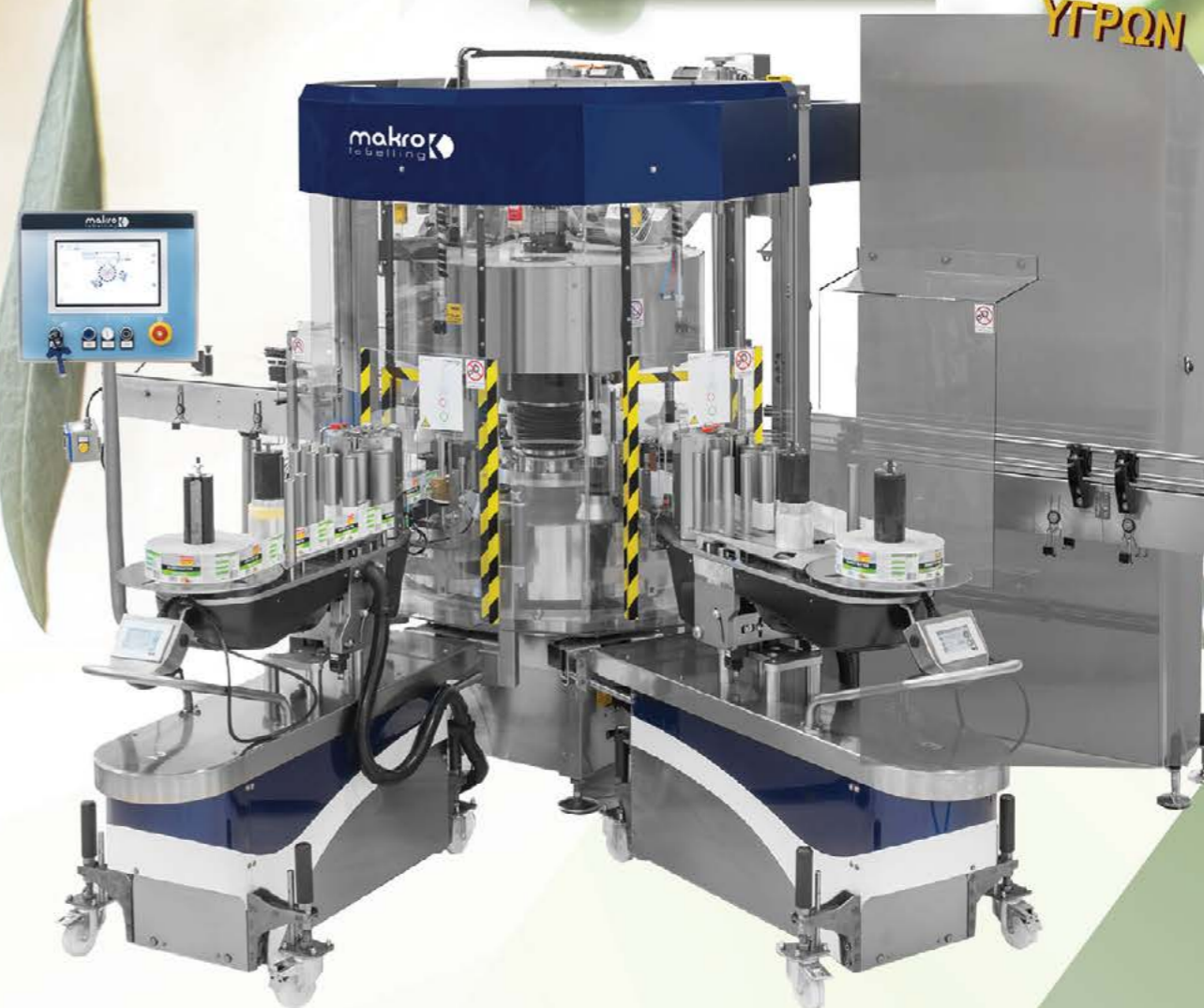
ΑΥΤΟΜΑΤΗ ΠΕΡΙΣΤΡΟΦΙΚΗ ΜΗΧΑΝΗ ΤΟΠΟΘΕΤΗΣΗΣ ΑΥΤΟΚΟΛΛΗΤΩΝ ΕΤΙΚΕΤΩΝ ΜΕ ΣΤΑΘΜΟΥΣ SERVO ΚΑΙ PLC.
