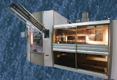
ΜΟΝΟΜΠΛΟΚ ΜΗΧΑΝΗΜΑ ΚΑΤΑΣΚΕΥΗΣ ΚΑΙ ΕΜΦΙΑΛΩΣΗΣ ΦΙΑΛΩΝ PET
