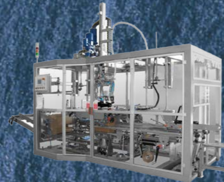
ΕΓΚΙΒΩΤΙΣΤΗΣ ΤΥΠΟΥ COMBI ΓΙΑ ΤΗΝ ΔΙΑΜΟΡΦΩΣΗ ΤΟΥ ΧΑΡΤΟΚΙΒΩΤΙΟΥ, ΤΩΝ ΕΓΚΙΒΩΤΙΣΜΟ, ΚΑΙ ΤΗΝ ΚΟΛΛΗΣΗ ΤΟΥ ΧΑΡΤΟΚΙΒΩΤΙΟΥ.
