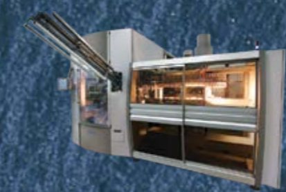
ΜΟΝΟΜΠΛΟΚ ΜΗΧΑΝΗΜΑ ΚΑΤΑΣΚΕΥΗΣ ΚΑΙ ΕΜΦΙΑΛΩΣΗΣ ΦΙΑΛΩΝ PET
