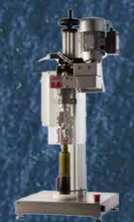
ΗΜΙΑΥΤΟΜΑΤΟ ΤΑΠΩΤΙΚΟ ΓΙΑ ΠΩΜΑΤΑ ΜΕΤΑΛΛΙΚΑ ΒΙΔΩΤΑ
