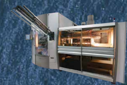
ΜΟΝΟΜΠΛΟΚ ΜΗΧΑΝΗΜΑ ΚΑΤΑΣΚΕΥΗΣ ΚΑΙ ΕΜΦΙΑΛΩΣΗΣ ΦΙΑΛΩΝ PET
