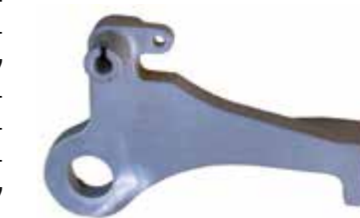
Μάνταλο αντικατάστασης για κάθισμα βιομηχανικού ελκυστήρα 3D εκτυπωμένο από ανοξείδωτο χάλυβα στο Shop System, πάνω αριστερά.
