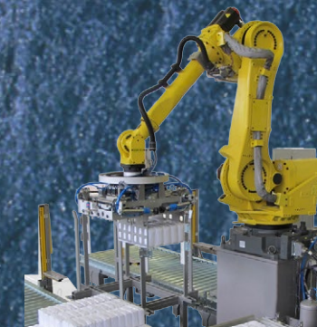
ΠΑΛΕΤΟΠΟΙΗΤΗΣ ΤΥΠΟΥ ROBOT ΓΙΑ ΤΗΝ ΑΥΤΟΜΑΤΗ ΠΑΛΕΤΟΠΟΙΗΣΗ ΧΑΡΤΟΚΙΒΩΤΙΩΝ-ΔΕΜΑΤΩΝ
