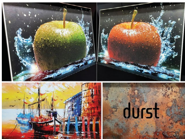
Πάνω: Lenticular εκτύπωση Κάτω: Harp-Printing με ανάγλυφη επιφάνεια, με πραγματική αίσθηση πίνακα ζωγραφικής αριστερά και σκουριάς δεξιά
