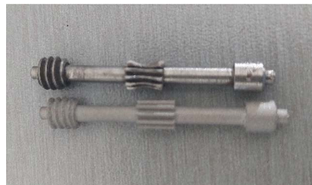
Αρχικός και κατασκευασμένος με LPBF άξονας, στην ίδια κλίμακα και πριν την τελική μετεπεξεργασία.
