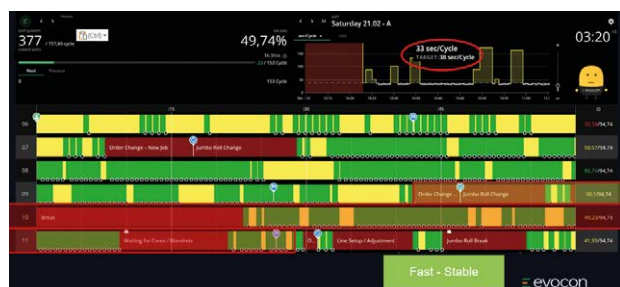
Πραγματική καταγραφή Evocon: Fast & Stable. Τα συνεχόμενα πράσινα τμήματα αποτελούν στοιχεία προς εξέταση, όχι απόδειξη ότι απουσιάζουν όλες οι απώλειες.
